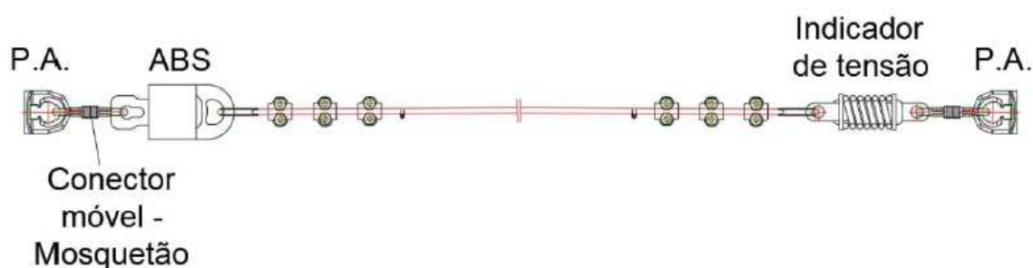
Detalhe de instalação das linhas de Vida Montagem da Linha de Vida
